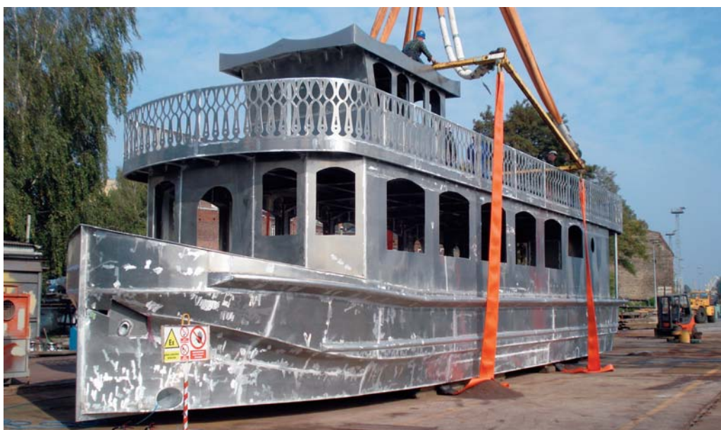
Aluminiowa konstrukcja statku / Aluminium construction of ship
